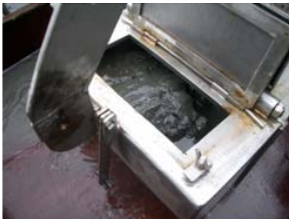
Figur 2. van Veen grabb med inspeksjonsluke
