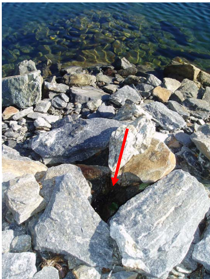
Figur 2. "Minideponiet" med sulfidstein i Kaldvellfjorden var en strandkantutfylling der noe av materialet lå i tidevanns- og bølgeslagssonen. Prøvetakingen i steinmassen ble gjort i en brønn sentralt i massen (markert med pil). Brønnen ble tom i perioder med lav vannstand og oversvømt i perioder med høy vannstand.
