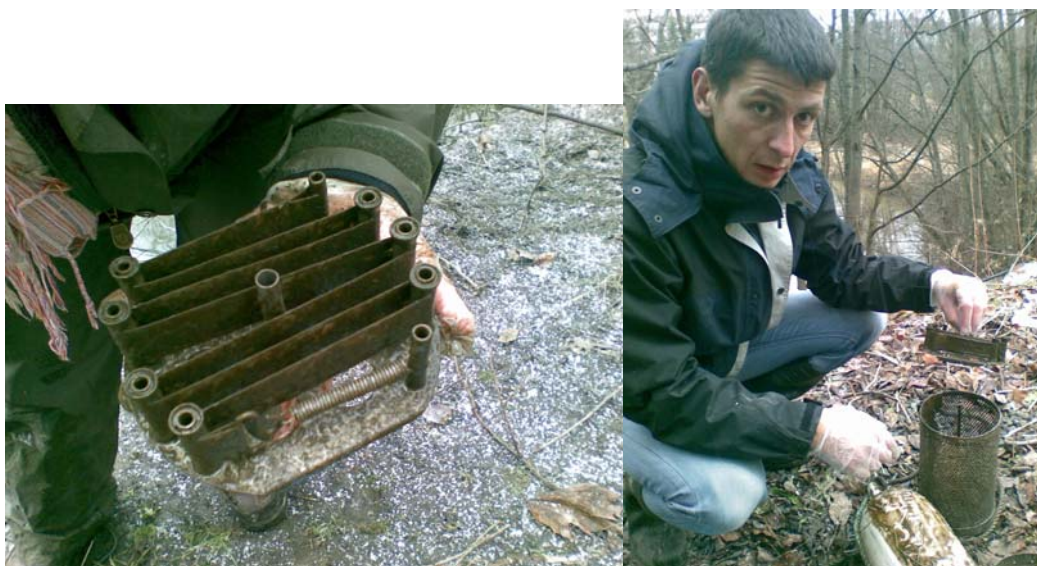
Bilde 2. SPMDer (venstre) og holder hvor de ble plassert (høyre).
