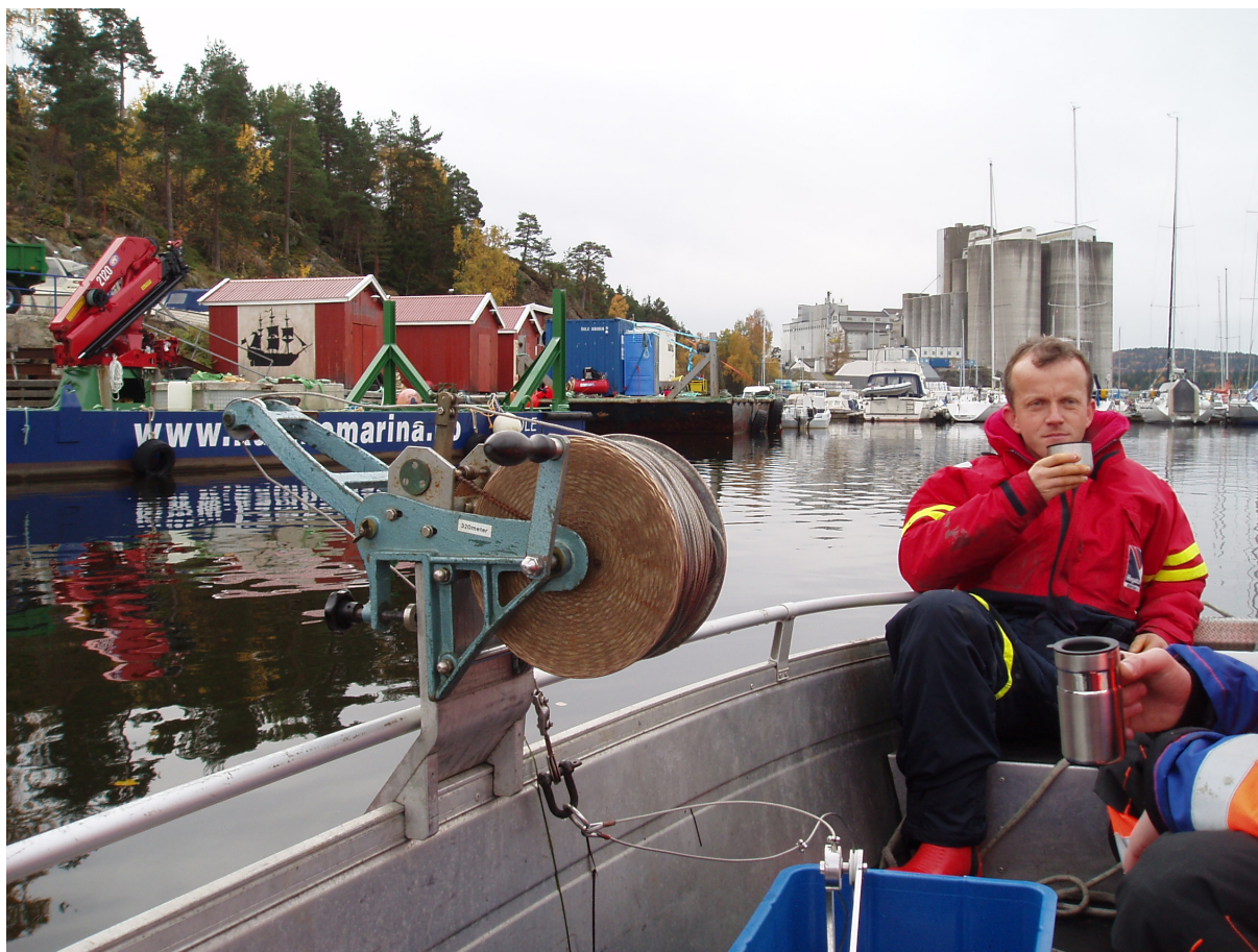
Figur 1. Benyttet båt (Buster L) med påmontert vinsj for prøvetaking. Bildet er tatt omtrent på stasjon 13. (Foto: John Arthur Berge).
