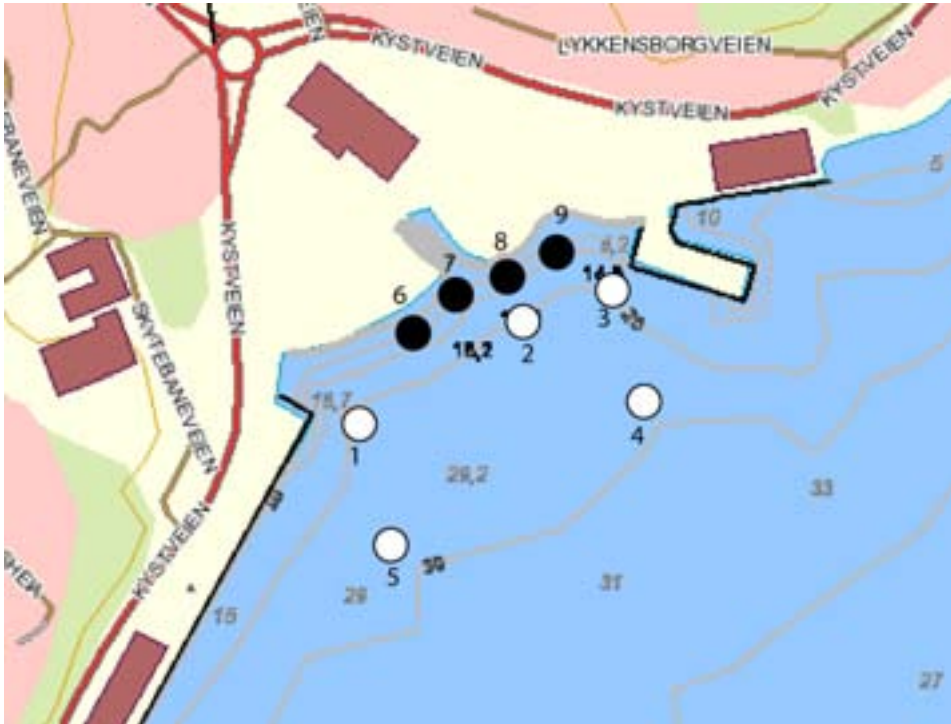
Figur 2. Kart som viser plassering av sedimentstasjoner i Barbusbukta. Svarte sirkler er stasjoner i fyllingskanten, hvite sirkler er stasjoner utenfor fyllingskanten.
