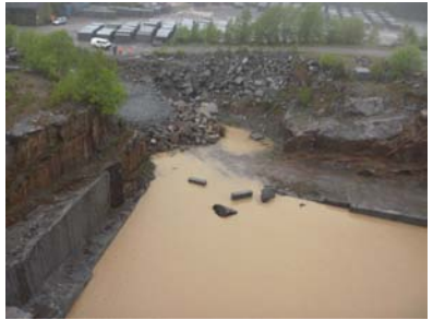
4. Sagvannet samles i bunnen av bruddet, men må pumpes ut etter hvert
