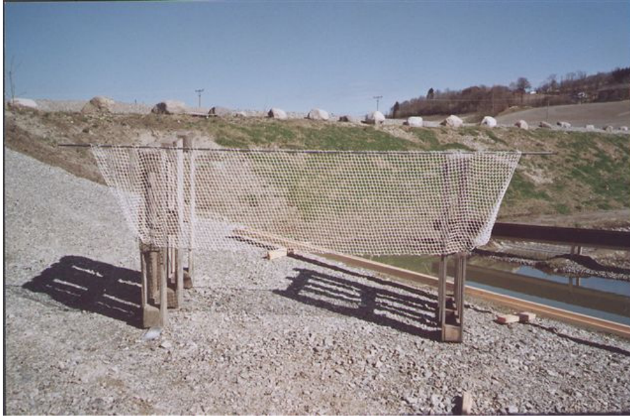
Figur 137. Sildenota klippes i 2x1 m og det tres innpå et armeringsjern som er litt lenger enn bredden på containerne. I bunn av garnet er det tredd på en vanlig bunntendel.
