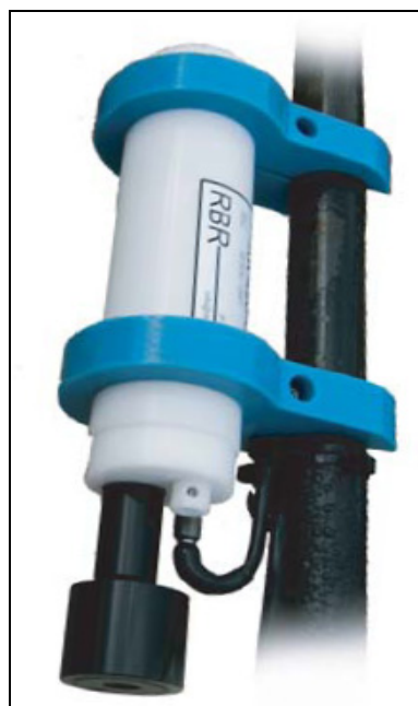
Figur 4. Temperaturloggere av merke RBR ble benyttet til målingene ved Haugsneset.
