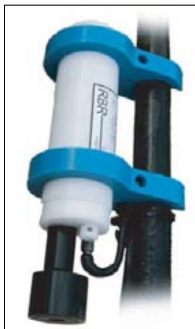
Figur 4. Temperaturlogger av merke RBR ble benyttet til målingene ved Haugsneset.
