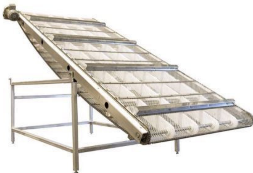
Figur 7. Sekundærsikring som forhandles av Unik Filtersystem. Alt avløpsvannet passerer den grove filterduken og fisk som har kommet i avløpssystemet vil hindres i å rømme ved at de langsgående metallslissene fanger opp fisken og overfører den til et kar.
