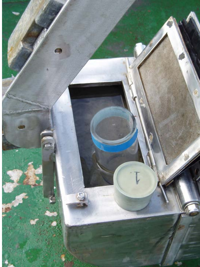
Figur 2. Uttak av sediment ved hjelp av et plastrør med kork fra luke på grabb.
