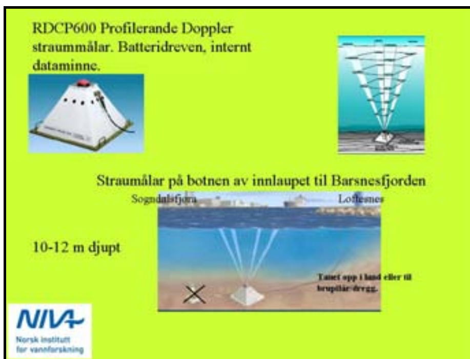
Figur 11. Opplegg for måling av strøm med profilerande Doppler (ADCP) målar.
