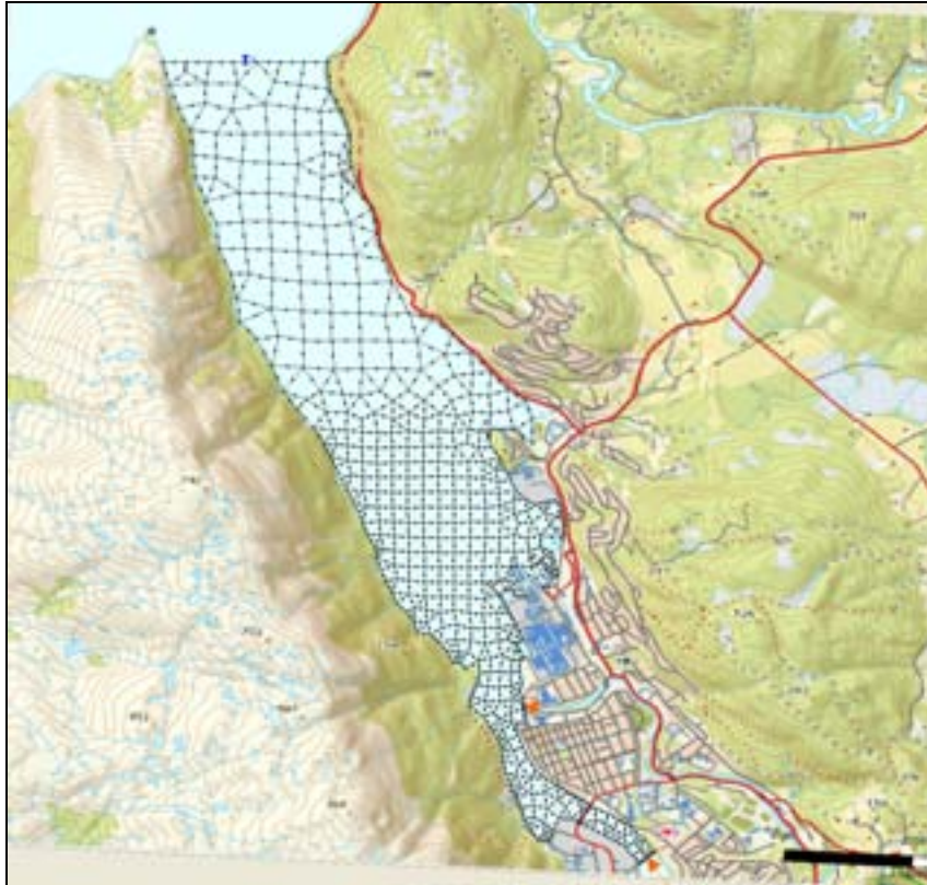
Figur B1 Nettverket eller gridet i RMA2-modellen for simulering av sirkulasjon. Nettverket består av trekanter og firkanter. I ytre del er sidelengden 20 m og i indre del er sidelengden 10 m. I hvert hjørne og midt på hver side (noder) beregnes høyden over referansedypet, strømretningen og strømhastigheten.
