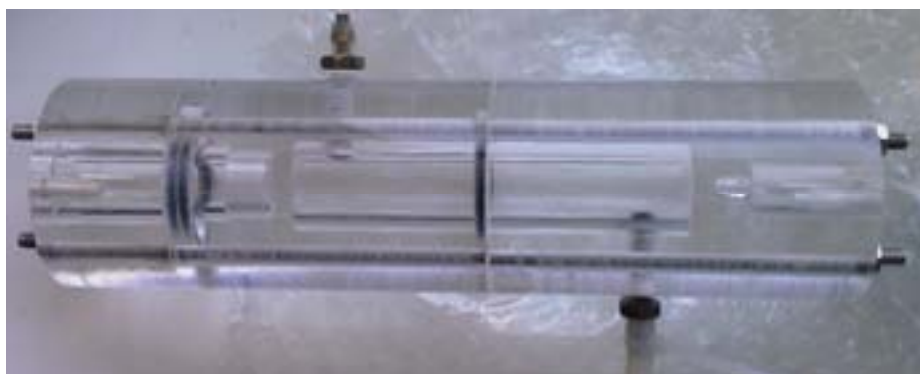
Figur 58. Gjennomstrømnings celle for in situ pH målinger utviklet ved Bjerknessenteret for klimaforskning.
