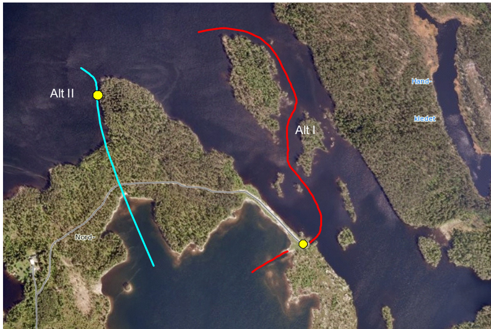
Figur 25. Eksempelvis alternativer for overføring av vann fra Handkledypet (Våja), Alt 1 å skjote på dagens inntak med en PE-ledning og legge pumpestasjon i dagens lukehus i dammen, Alt 2 legge opp et helt nytt overføringssted hvis man trenger å pumpe og må ha pumpen på trykksida. Flere traseer kan være mulig. En eventuell ny rørbasert overføring må utredes i en egen utredning.
