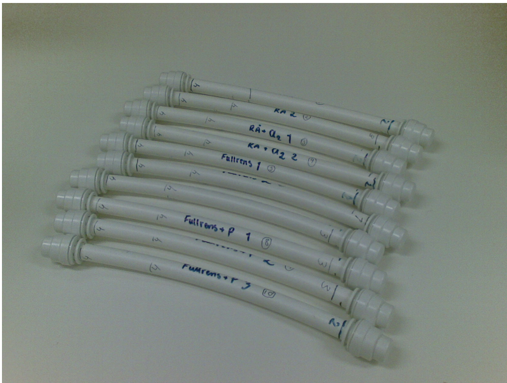
PEX-rør (10 stk) med plugg i begge ender.
