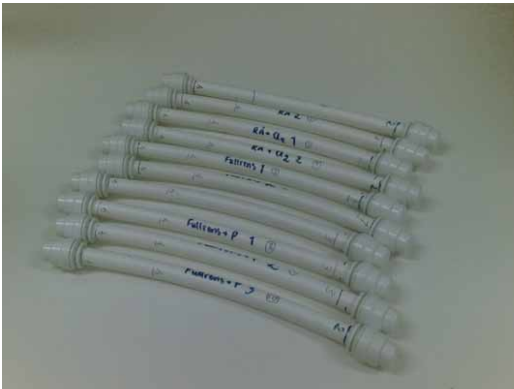
PEX-rør (10 stk) med plugg i begge ender.
