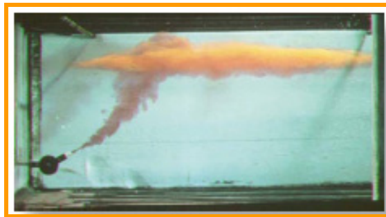
Figur 28. Foto frå laboratorieforsøk med farga oppstigande (lett, ferskt) vatn i ei sjikta væske (sjøvatn).
