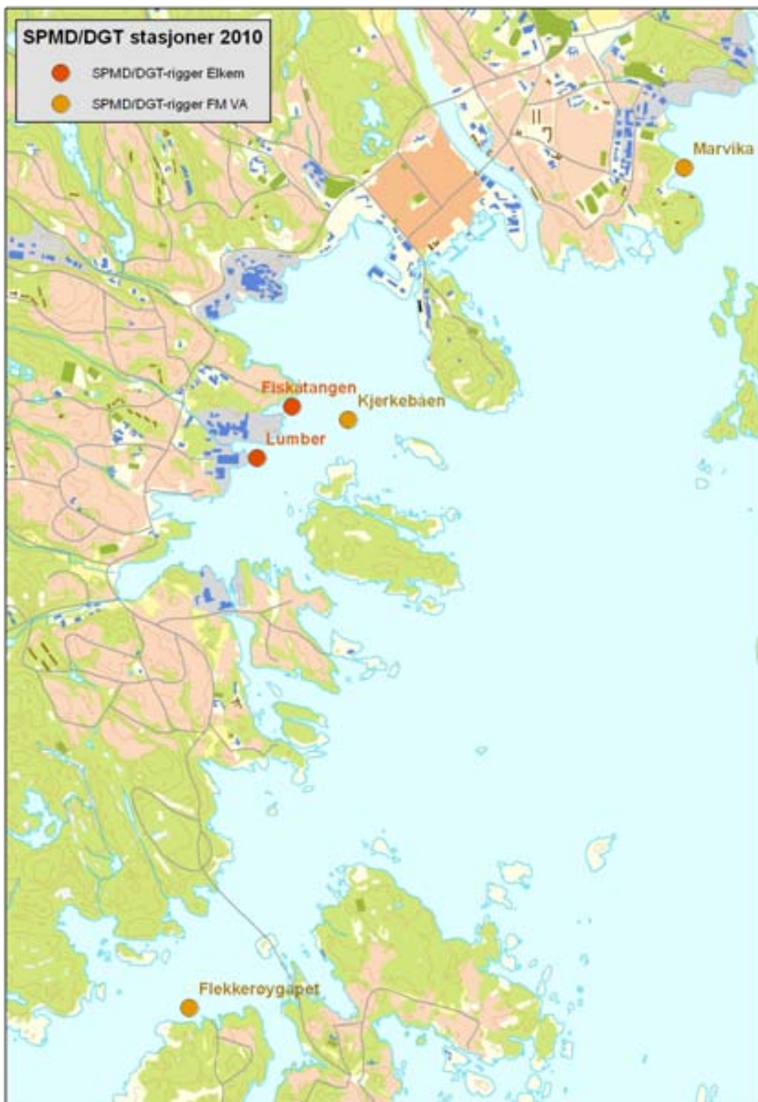
Figur 6. Oversiktskart over utplasserte passive prøvetakere SPMDer og DGTer i Kristiansandsfjorden. Tre SPMD/DGT-rigger tilhører overvåkingsprosjektet for Fylkesmannen og to SPMD/DGT-rigger tilhører Elkems program.
