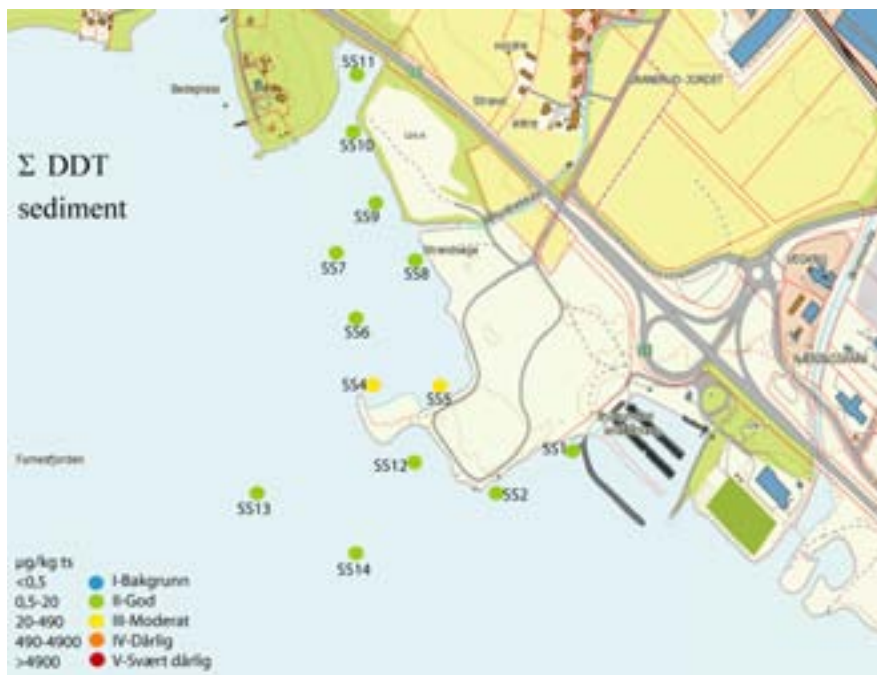
Figur 14. Tilstandsklasser for sum DDT i henhold til klassegrenser for sedimenter.
