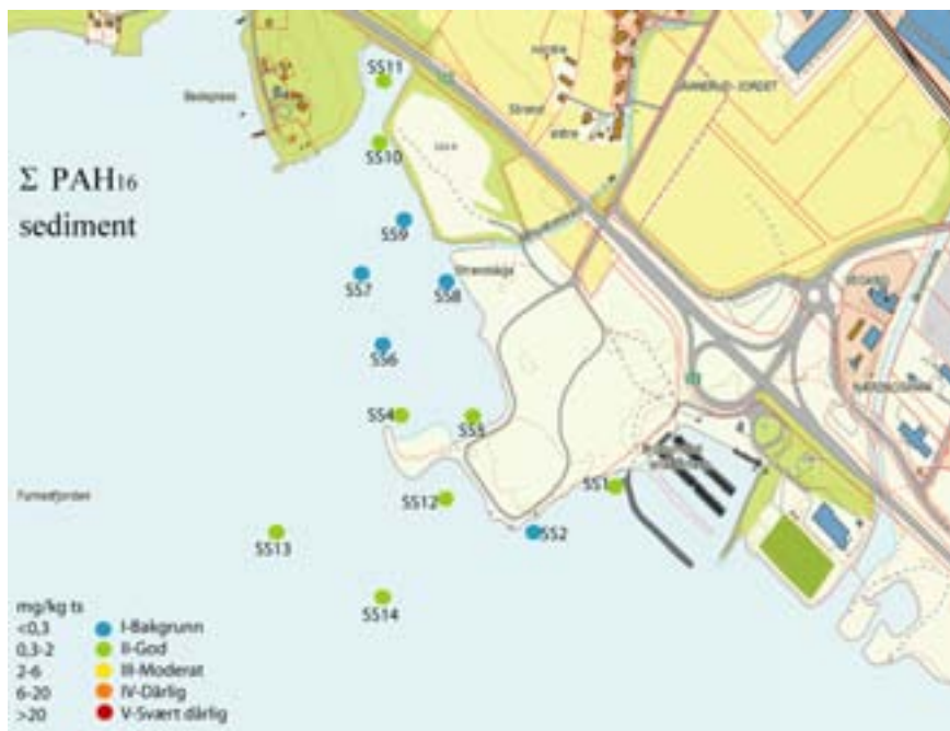
Figur 19. Tilstandsklasser for sum PAH-16 i henhold til klassegrenser for sedimenter.
