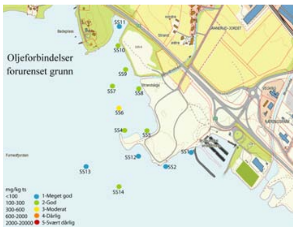
Figur 17. Tilstandsklasser for oljeforbindelser (fraksjon >C12-C35) i henhold til klassegrenser for forurenset grunn.
