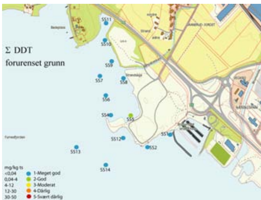
Figur 15. Tilstandsklasser for sum DDT vurdert i forhold til klassegrenser for forurenset grunn.
