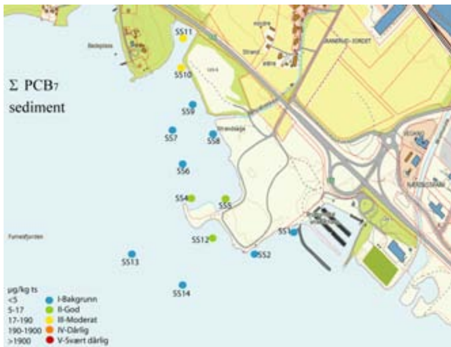
Figur 11. Tilstandsklasser for sum PCB 7 vurdert i henhold til klassifiseringsveileder for sedimenter (Bakke mfl. 2007).
