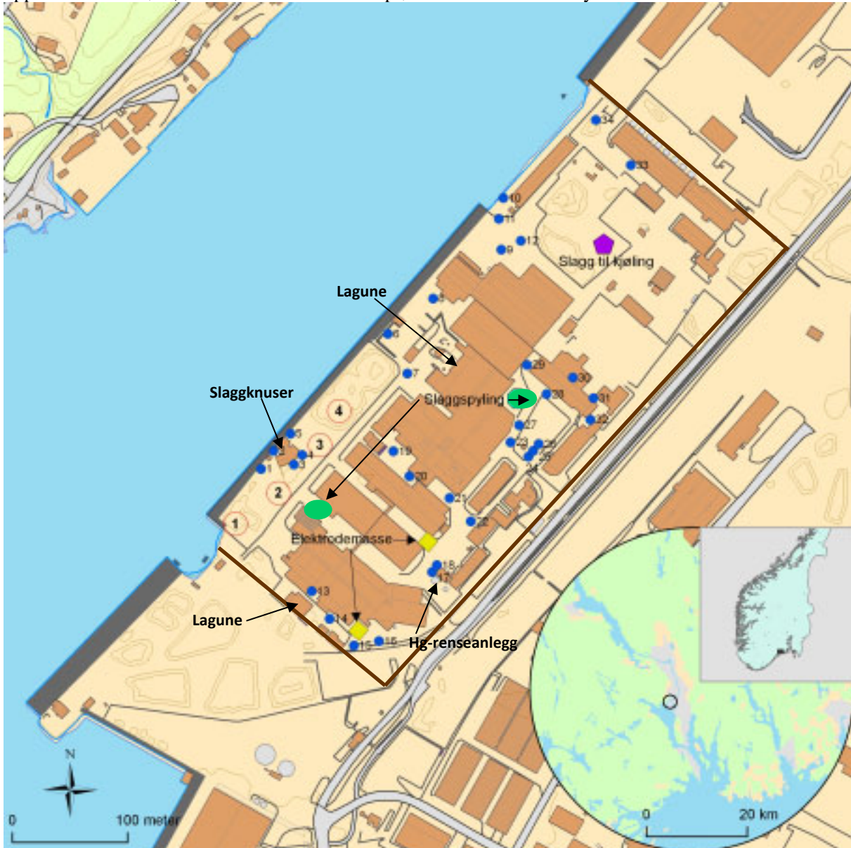
Figur 5. Beliggenhet av ENP i Norge, aktiviteter og oppbevaring av materialer på tomte. ENP-tomtens areal er rammet inn med brune linjer. De blå fylte sirklene med nummer angir kummer og deres tilhørende ENP-nummer. Sirkler med nummer angir ulike materiale som oppbevares utendørs: 1= ømsmelt; 2= kvarts; 3=HC-slagg og 4=koks.
