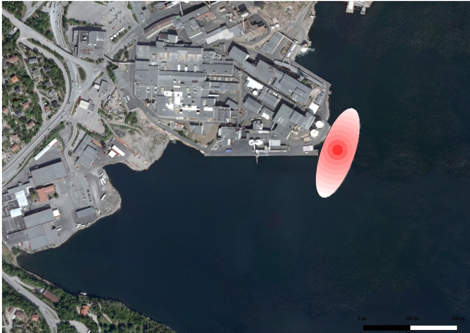
Figur 10. Illustrasjon av skyen med innlagret avløpsvann. Utenfor noen titalls meter vil vannkvaliteten tilsvare God (klasse II).
