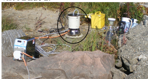
Bilde 2. Kontinuerlig vannstrømsentrifuge.
