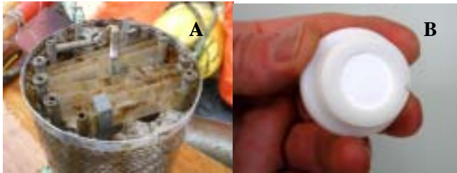
Bilde 1. a) Passive prøvetakere av typen SPMD og b) av typen DGT.
