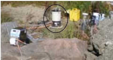
Bilde 2. Kontinuerlig vannstrømsentrifuge.
