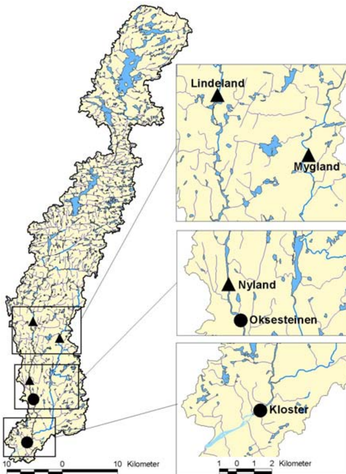
Figur 1. Kart over nedbørfeltet til Kvina med utslag av tre områder i stor målestokk som viser plasseringen av kalkdoserere (triangler) og pH-målestasjoner (sirkler).
