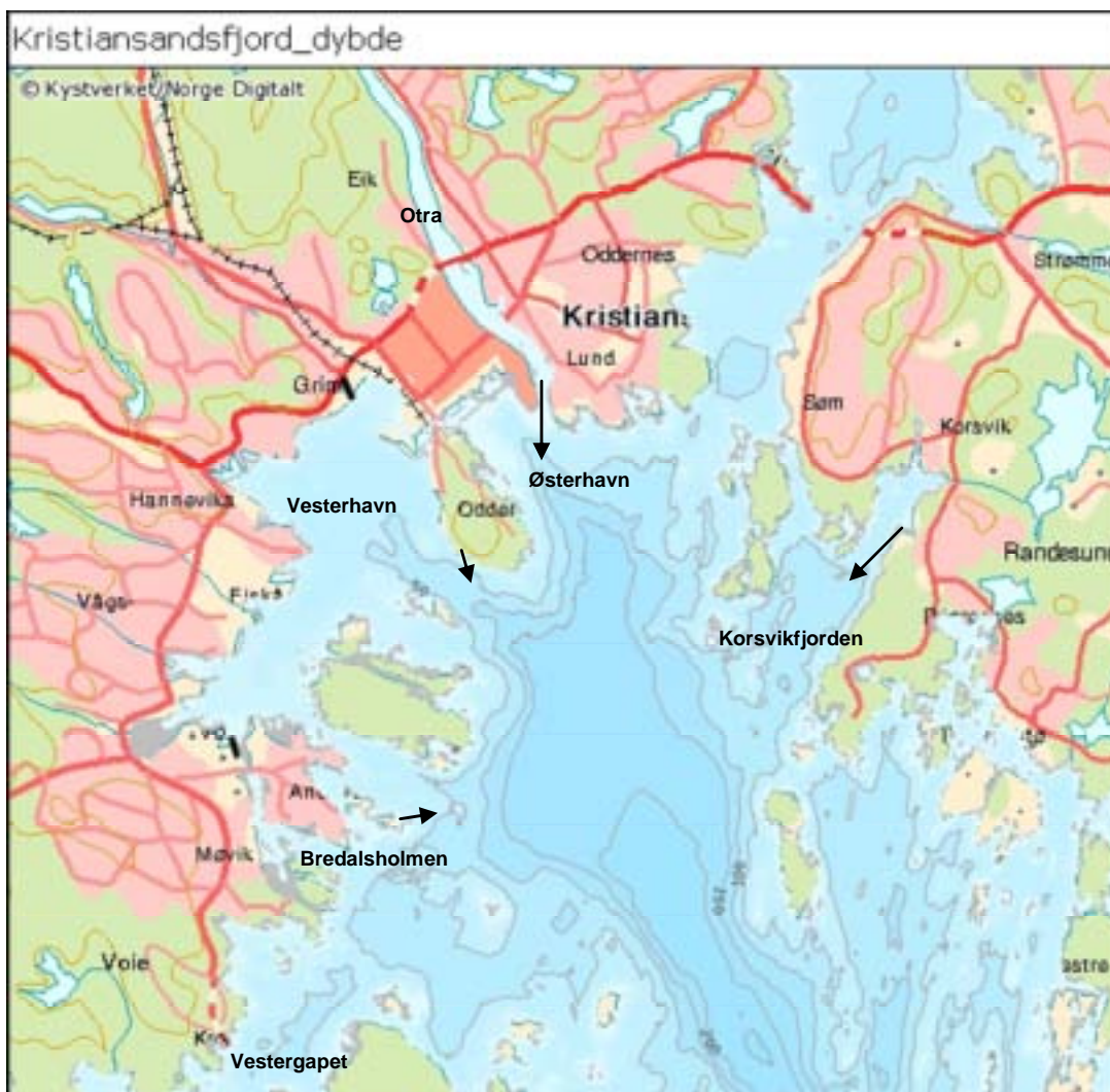
Figur 1. Oversiktskart med dybdeforhold i Kristiansandsfjorden. Plassering av utslippspunkter for avløpsvann fra kommunens renseanlegg og Otraledningen er markert med sorte piler.
