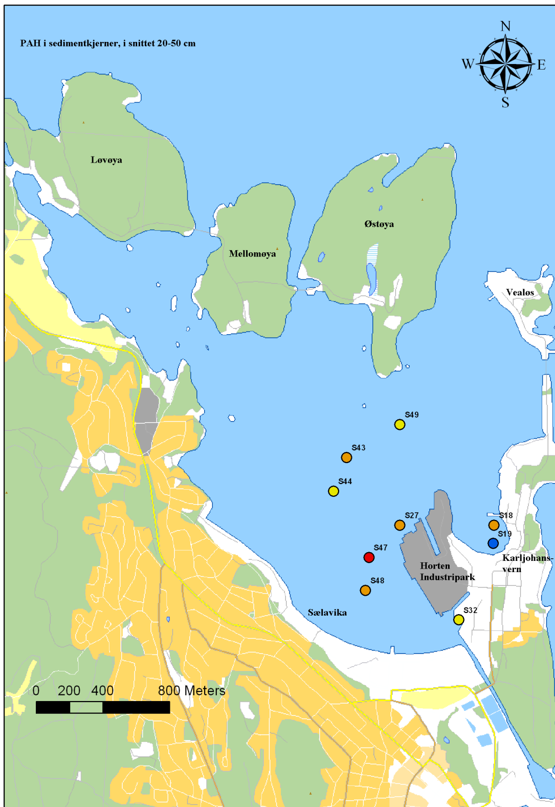
Figur 20. Oversiktskart over Horten Indre Havn med tilstandsklasser for PAH i sediment i snittet 20-50 cm. Figuren er gitt fargekoder i henhold til Klifs klassifiseringssystem (Bakke m.fl. 2007).
