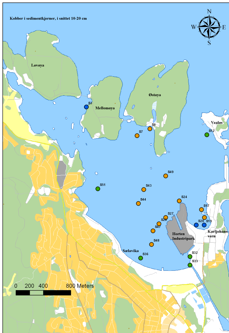
Figur 13. Oversiktskart over Horten Indre Havn med tilstandsklasser for Cu i sediment i snittet 10-20 cm.. Figuren er gitt fargekoder i henhold til Klifs klassifiseringssystem (Bakke m.fl. 2007).
