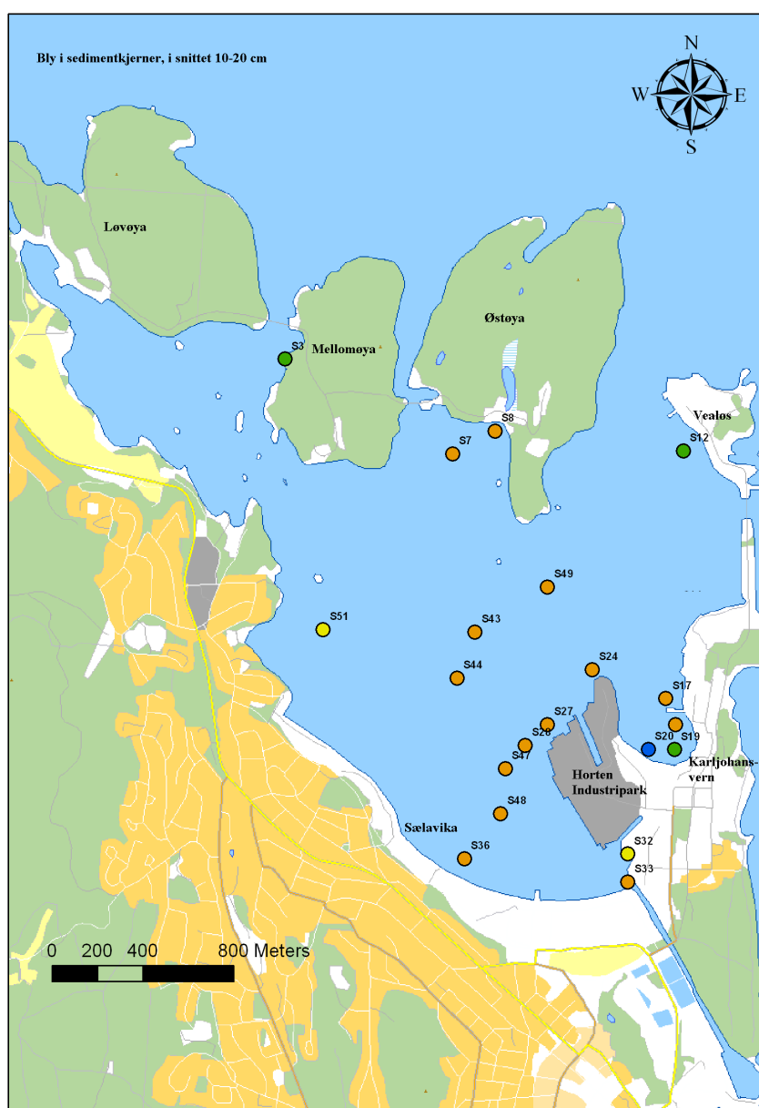
Figur 10. Oversiktskart over Horten Indre Havn med tilstandsklasser for Pb i sediment i snittet 10-20 cm. Figuren er gitt fargekoder i henhold til Klifs klassifiseringssystem (Bakke m.fl. 2007).
