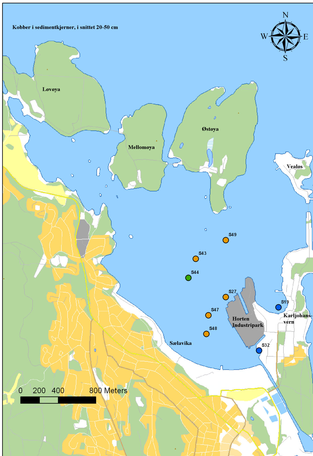
Figur 14. Oversiktskart over Horten Indre Havn med tilstandsklasser for Cu i sediment i snittet 20-50 cm.. Figuren er gitt fargekoder i henhold til Klifs klassifiseringssystem (Bakke m.fl. 2007).
