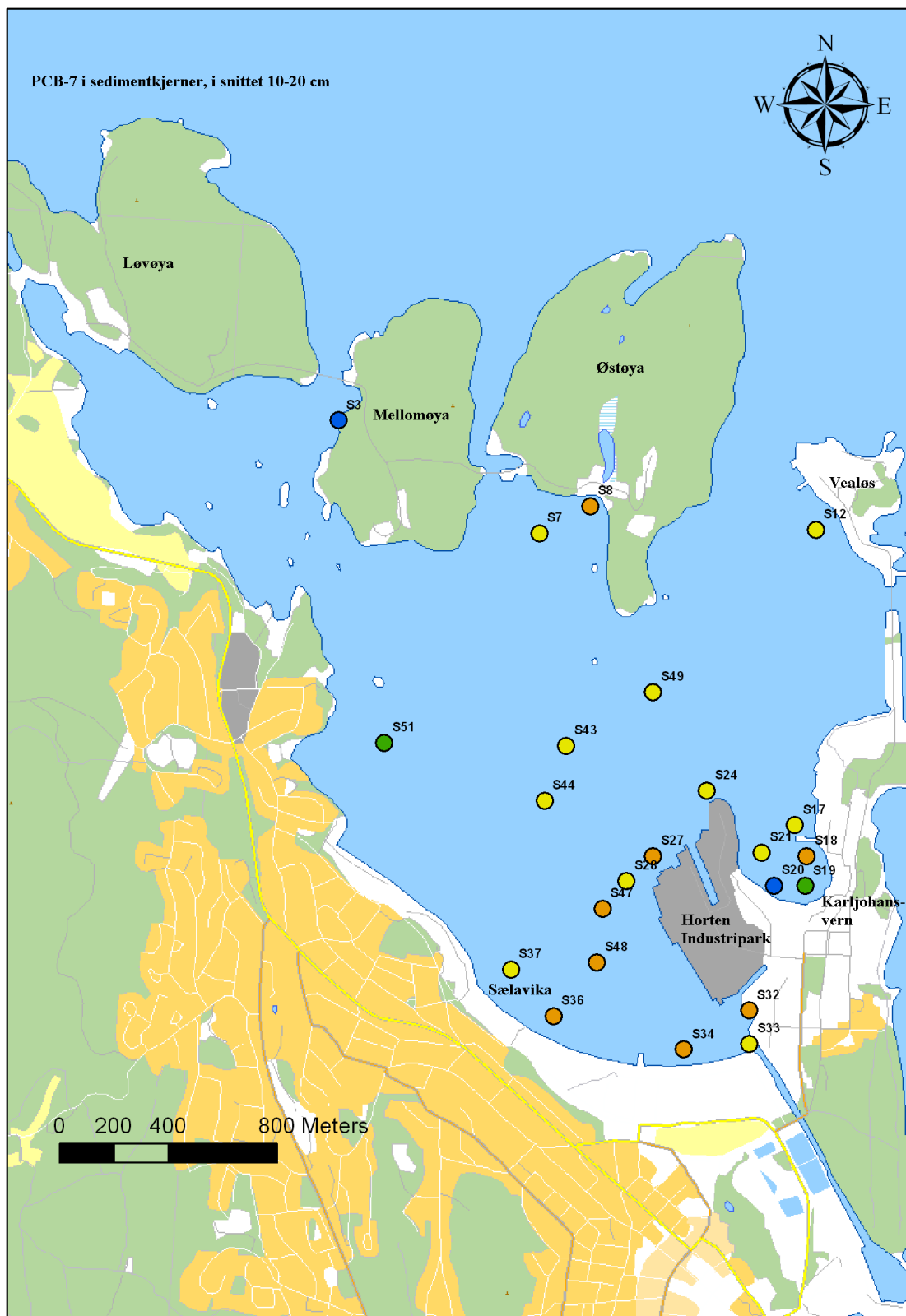
Figur 16. Oversiktskart over Horten Indre Havn med tilstandsklasser for PCB-7 i sediment i snittet 10-20 cm. Figuren er gitt fargekoder i henhold til Klifs klassifiseringssystem (Bakke m.fl. 2007).
