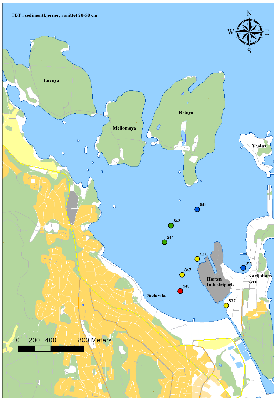
Figur 23. Oversiktskart over Horten Indre Havn med tilstandsklasser for TBT i sediment i snittet 20-50 cm.. Figuren er gitt fargekoder i henhold til Klifs klassifiseringssystem (Bakke m.fl. 2007).
