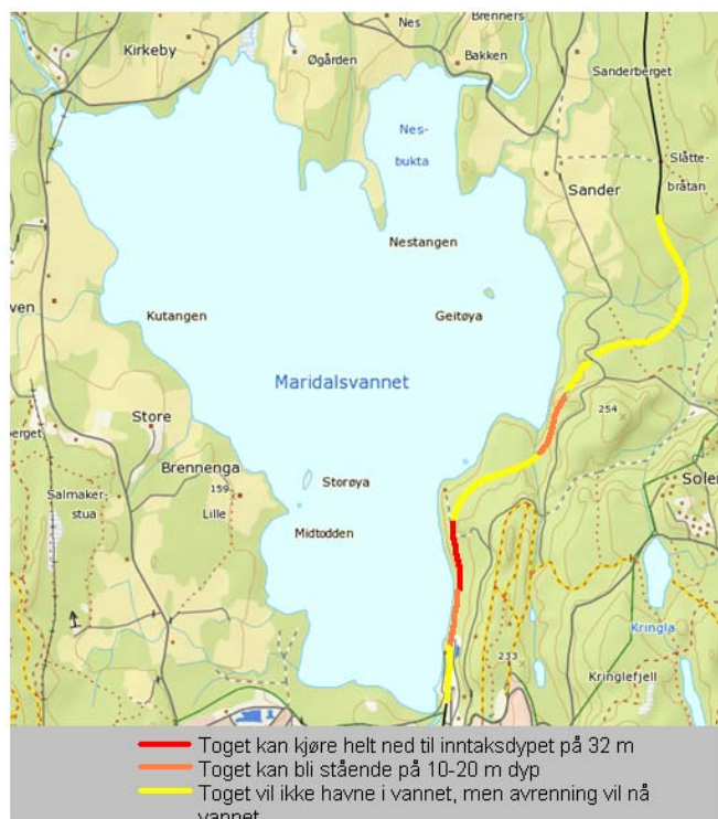
Figur 3-43. Strekninger med anslagsvis gradering av farligheten av en avsporing av godstog med farlig last (olje-kjemikalier).
