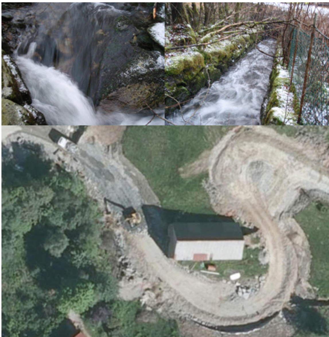
Figur 24. Eldre og nye inngrep i Nitterelva oppstrøms hovedveien 55 kan ha flere problempunkter mht fiskevandring, men grundige vurderinger ble ikke foretatt. Øverst til venstre viser kanalisering av bekken over glatt berg/fjell, som kan medføre passeringsproblemer.
