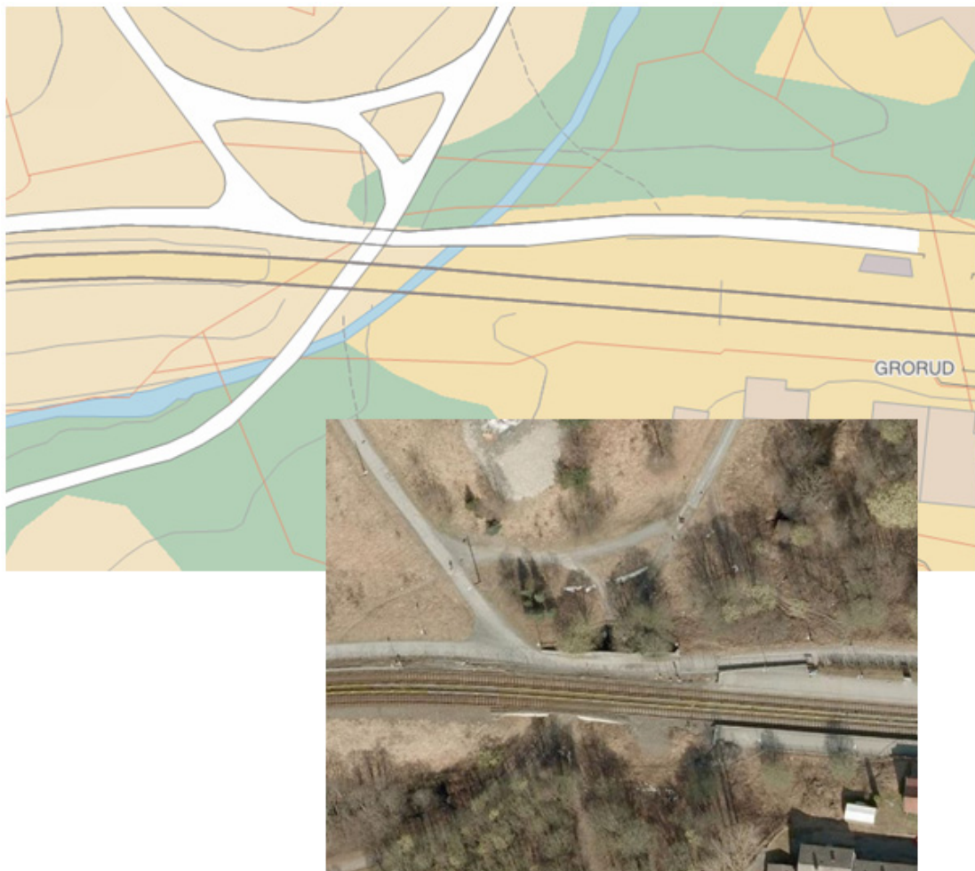
Figur 92. Potensielt problempunkt for vandringer av fisk oppstrøms stasjonsområde ALN2 i forbindelse med krysning av T-banelinja ved Grorud. www.finn/kart.no .
