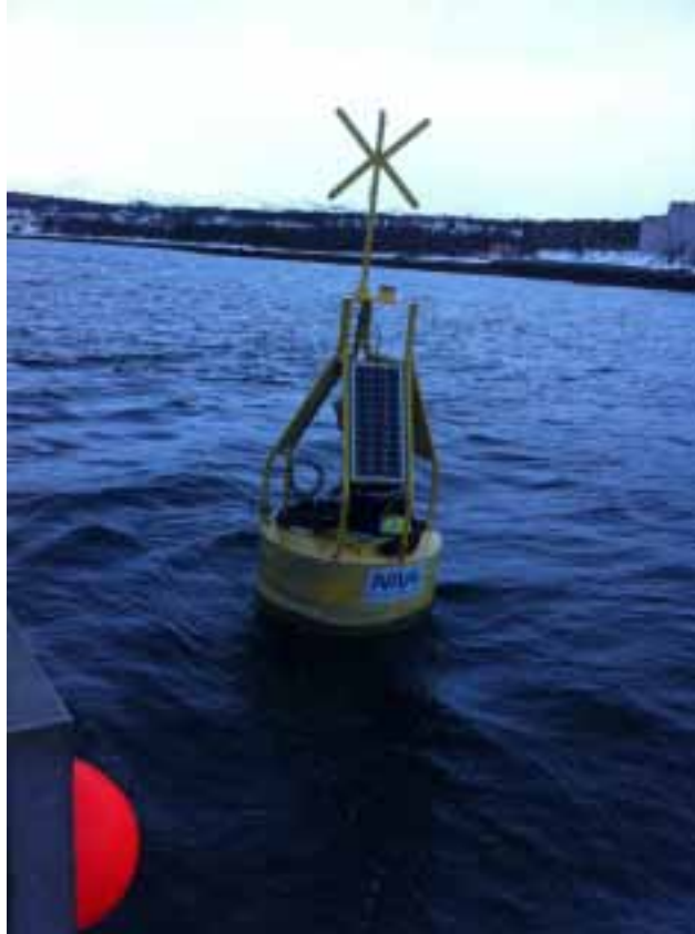
Figur 2. Marin målerigg med bøye i overflaten som markerer posisjon til rigg. Solcellepanel benyttes for å sikre kontinuerlig målinger uten bytte av batterier.
