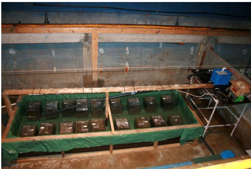
Figur 12. Fotografi av oppsettet for fluksmålingene i bløtbunns hallen på Solbergstrand.
