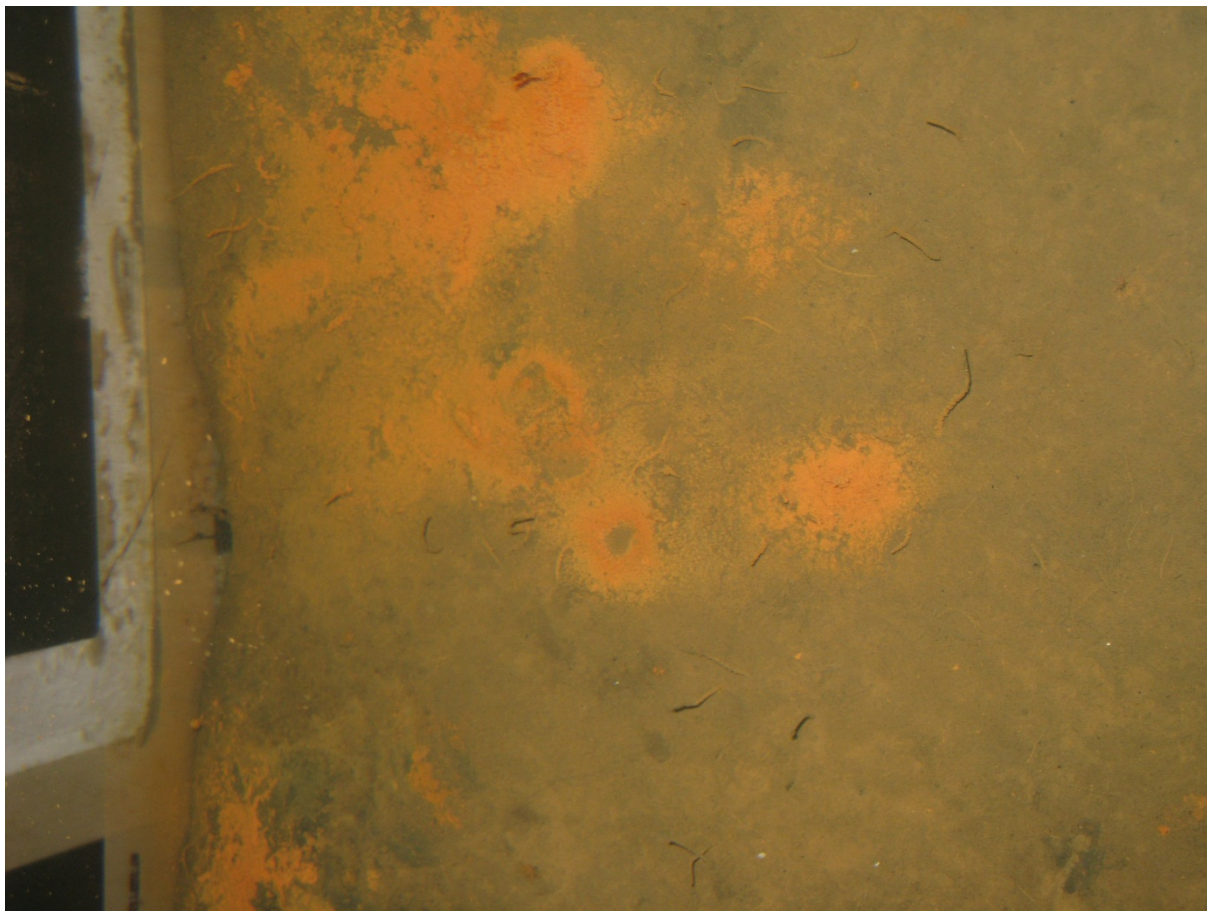
Figur 14. Bilde av sedimentoverflaten i boks 2 (område D) tatt 28.8.2012. Bildet viser hauger av gult materiale (sannsynligvis jarositt) kastet opp på sedimentoverflaten av dyr som lever i sedimentene.
