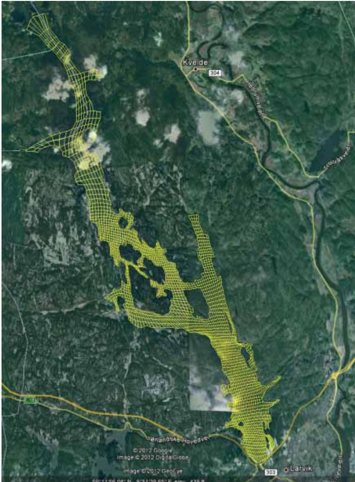
Figur 9. Innsjøen ble delt inn i beregningsceller. I horisontalplanet av variabel størrelse, mens vertikalt er hver celle 2 meter tykke. Celleinndelingen er helt ned til bunn av innsjøen.
