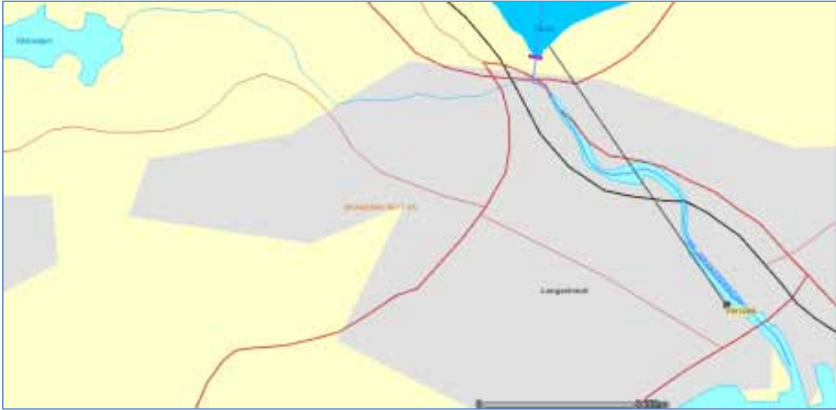
Figur 6. Farriselva med kraftverkstunnel og Fritzøe kraftverk. Oppstrøms utløpet fra Fritzøe kraftverk, er det bare bekken fra Kleivertjern som sørger for vannføring i Farriselva. I flomperioder kommer det også overløpsvann fra Farrisvannet (fra NVE Atlas).
