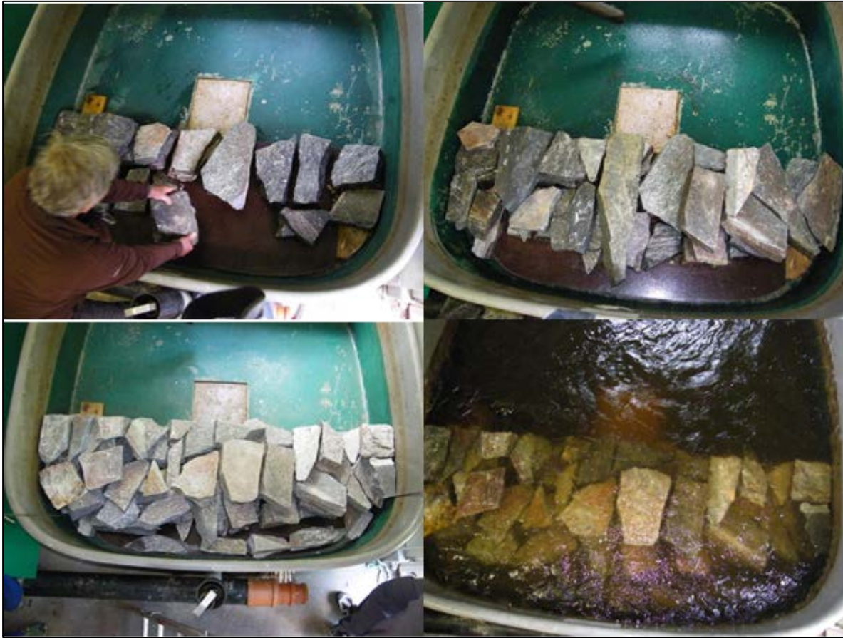
Figur 20. Oppbygging av kunstig liten steinforbygning for å etterlikne miljøforhold i elveforbygninger. Grov skifrig stein ble bygget opp i tre lag. Total høyde ble ca 40-50 cm, bredden ca 60 cm. Steinstøv og annet fint materiale ble skylt vekk før forsøk.
