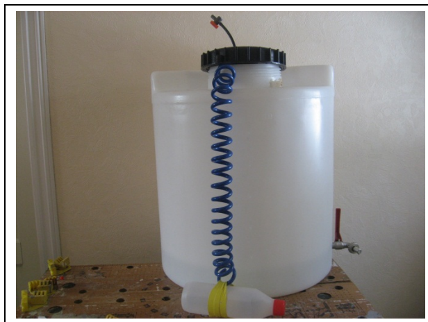
Figur 70. Spiralformet rør (her vist utenfor kannen) ble forsøkt brukt som motstand for innkommende luft.
