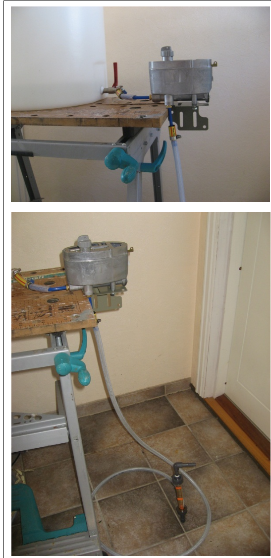
Figur 73. Forsøk med flottørventil koplet på utløpet og rotameter i enden.
