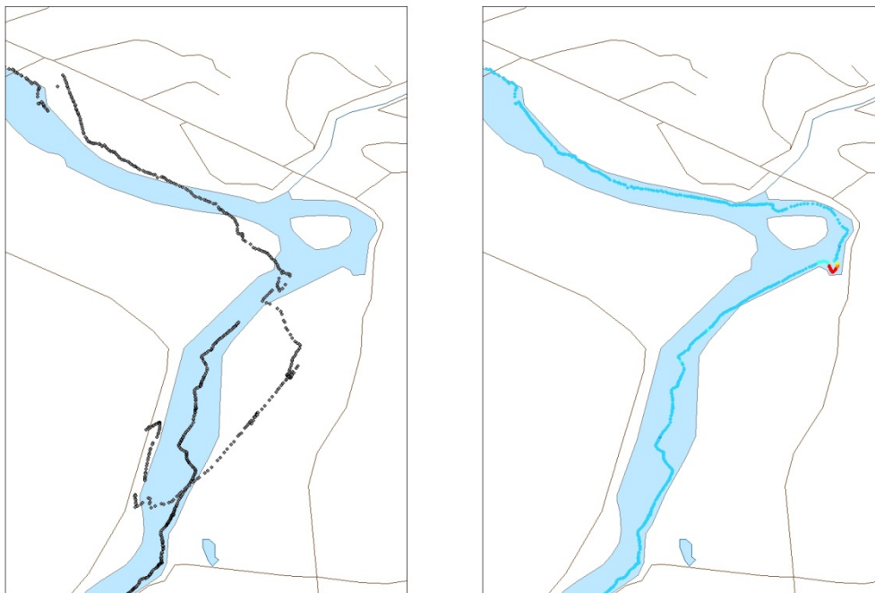
Figur 64. GPS-data før tilpasning til kartgrunnlaget (venstre) og etter (til høyre).
