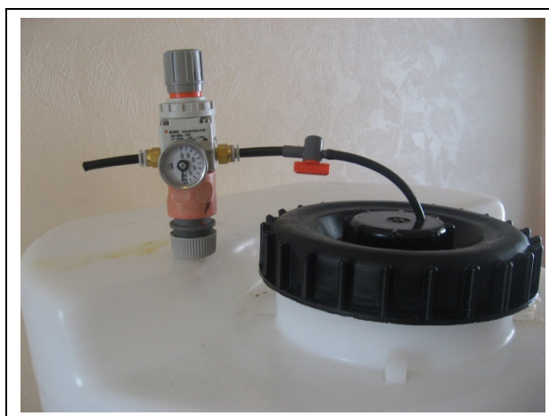
Figur 69. Forsøk med bruk av ventil for regulering av innkommende luft førte ikke fram.
