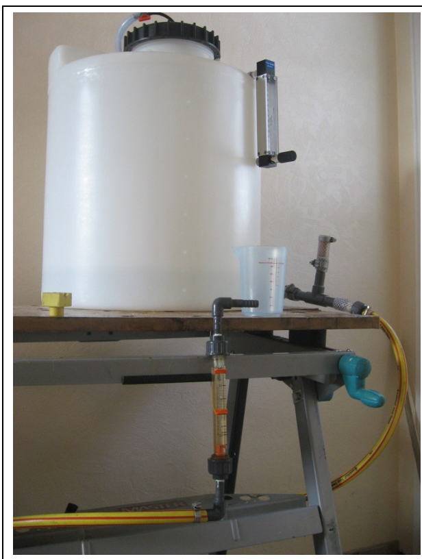
Figur 71. Forsøk med slange fra utløpsventilen (øverst) og innløpsventil (nederst).
