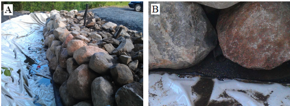
Figur 22. A: Forsøksdammen uten vann. B: Et vanlig drensrør ble også plassert i forsøksdammen.
