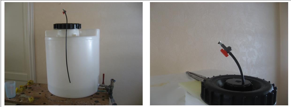
Figur 72. Forsøk med å montere et rett rør fra innløpet (venstre; røret vist utenfor kannen) og med enkel reguleringsskrue på slangestussen.
