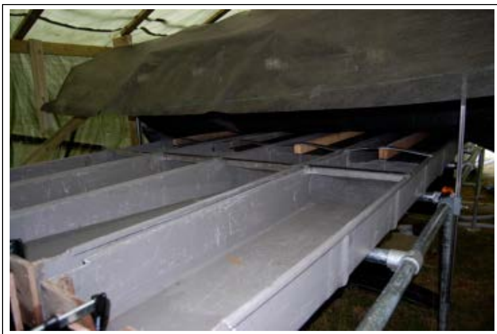
Figur 18. Bakre del av renna. På midten ses forsøkskammer for fisk, og øverst ses midtdeleren som deler hver renne. Kameraene er her skjult under sort filt.
