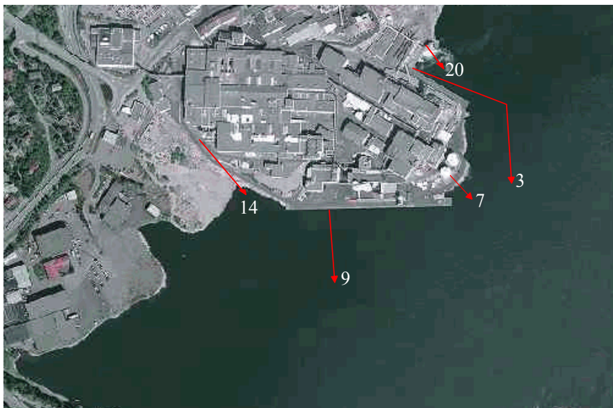
Figur 4. Hanneviksbukta med avløp som fører arsen. Avløp 7 er i særklasse størst.
