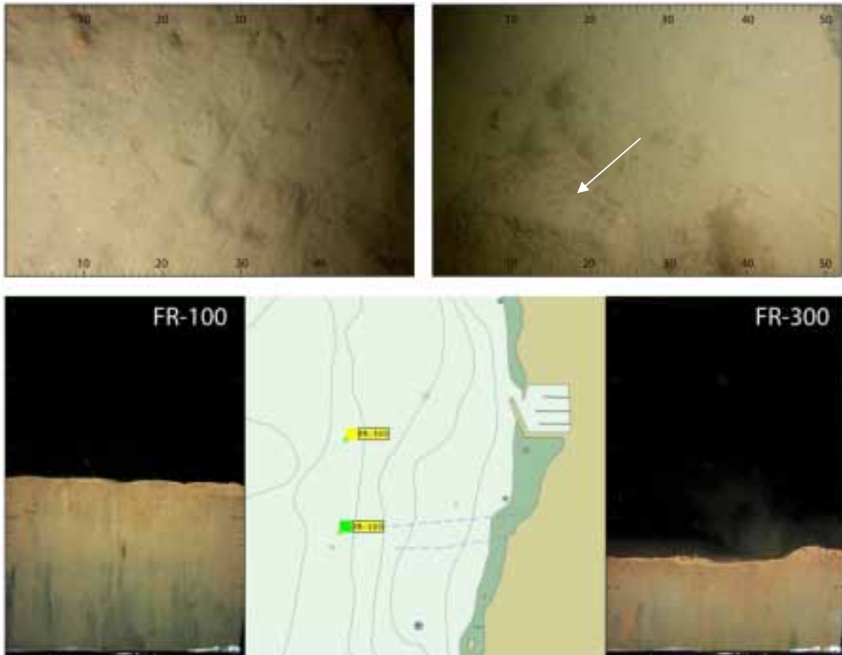
Figur 17. Fuglevik renseanlegg. Kart med undersøkte stasjoner, posisjon (grønn sirkel), status (grønn kvadrat), Sedimentoverflatebilde (SSI, pil viser innslag av fjellbunn) og sedimentprofilbilde (SPI) fra stasjon FR-100 (t.v.) og FR-300 (t.h.).
