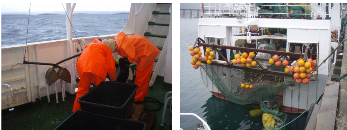
Figur 3. Venstre: Prøvetaking av bunnfauna med van Veen grabb ved Roddenes i Porsangerfjorden, 8. oktober 2011. Høyre: krabbetrål opphengt på hekken av F/F 'Johan Ruud'. Foto: Eivind Oug
