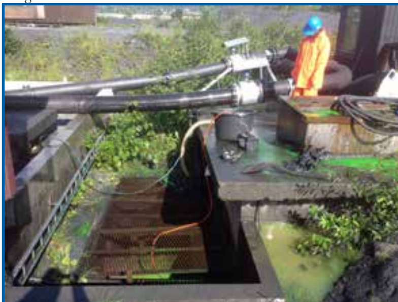
Figur 7. Dosering av sporstoffet (fortynna til 1:10) frå 50 liters stamp gjennom slange.
