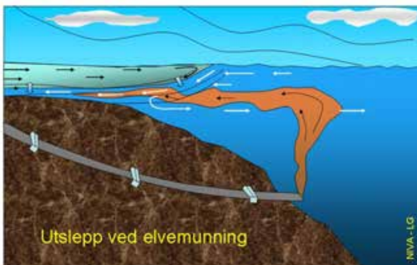
Figur 6. Skisse som viser eit utslepp nær ei elvemunning med ferskvasskile, og korleis utleppsvatn kan bli transportert i retning inn mot denne.
