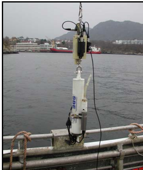
Figur 38. SAIV SD202 med sensorar, samt Seabird SBE-19 STD hengande under i samband med interkalibrering.
