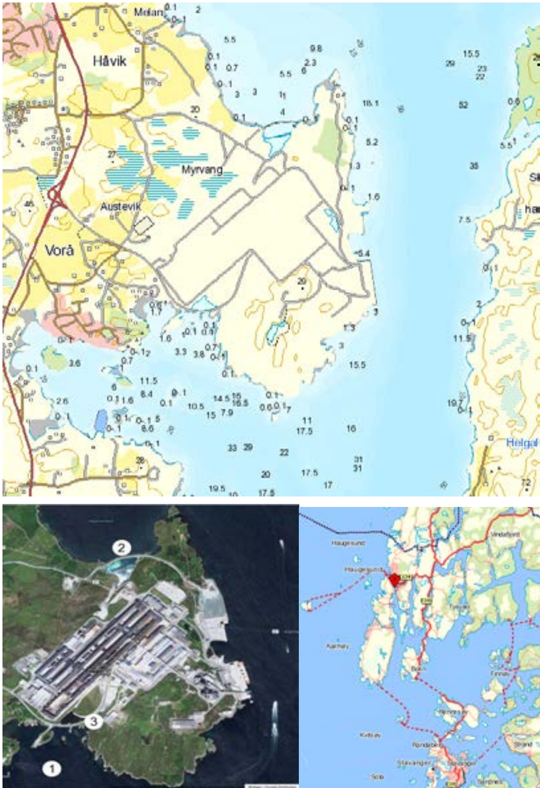
Figur 1. Beliggenhet av aluminiumsverket på Karmøy. Bildet viser de to fangdammene hhv nord (2) og syd (3) for verket. Bildet viser også posisjon for sjøvannsinntaket på 20m dyp (1). Fabrikkhallene med det gamle Söderberganlegget (de to lange bygningene til høyre) er revet og tomt opparbeidet for nye fabrikkbygninger.
