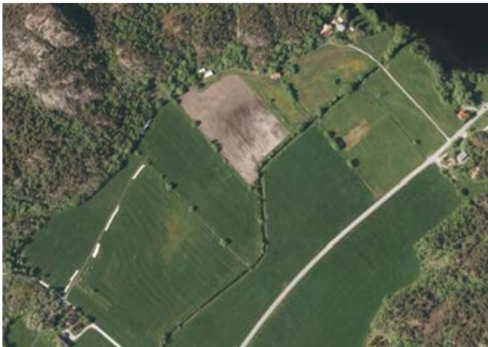
Figur 37. Flyfotoutsnitt (2012) fra Eidselva, som viser utrettet og kanalisert elvestrekning uten velutviklet kantvegetasjon. (Kilde: http://kart.finn.no/ )
