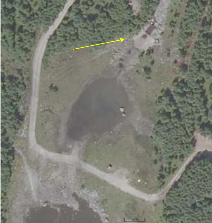
Figur 62. Fiskesperre (gul pil) ved utløpet av Sætranselva fra Sætransvatnet. Sætranselva går helt tørr i perioder med lite nedbør og om vinteren pga. fraføring av vann til settefiskproduksjon. Flyfoto fra 2009, hentet fra http://kart.finn.no/
