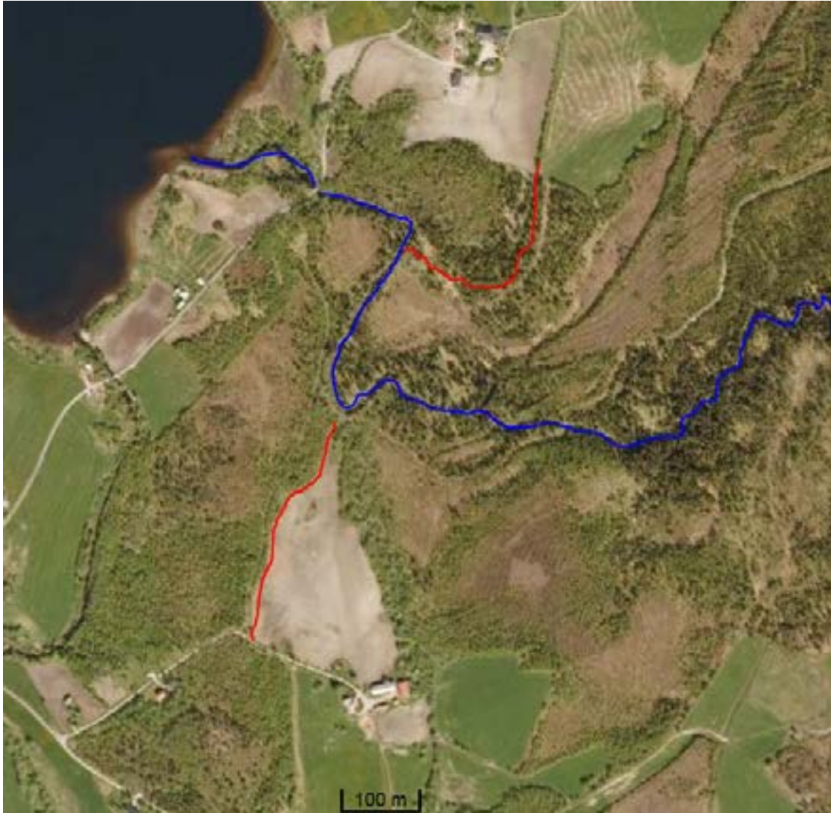
Figur 40. Potensielle avrenningskilder (rødt) som kan være årsaken til forhøyde bakterienivåer i Djupelvas (blått) nedre del. (Kartgrunnlag: http://kart.finn.no/ )
