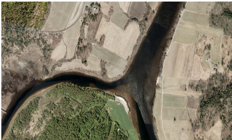
Figur 5.27 Sandbanken som er bygget opp i «pålandsodden» til Bjorsund bidrar til å sende en betydelig del (anslagsvis 1/3) av vannføringsøkning i Nidelva inn i Rore bare som følge av vannets bevegelsesenergi. Foto: Statens kartverk.
