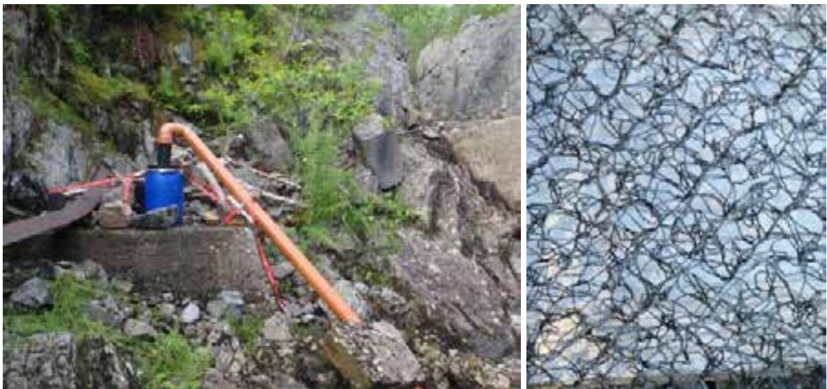
Figur 11. Oppvandringsfelle for ål plassert ved inngangen til nedre laksetrapp ved Fosstveit kraftverk (venstre foto). Enkammat (vevde plasttråder, høyre foto) ble lagt inn i røret for å hjelpe ålen med å vandre opp i fella. Foto: F. Kroglund
