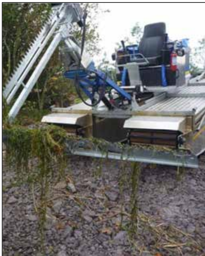
Figur 7. Truxor amfibiefartøy brukt av Bombus Natur AS til slått av smal vasspest i Bjårvatn. Bildet er hentet fra Johnsen (2012).
