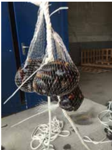
Figur 2. Blåskjell fordelt mellom tre nett ble hengt i tau fra Hovedkai og Dypvannskai på hhv. 4, 6 og 10 meters dyp. En tykk kjetting var festet i enden av tauet som lodd mot bunn.
