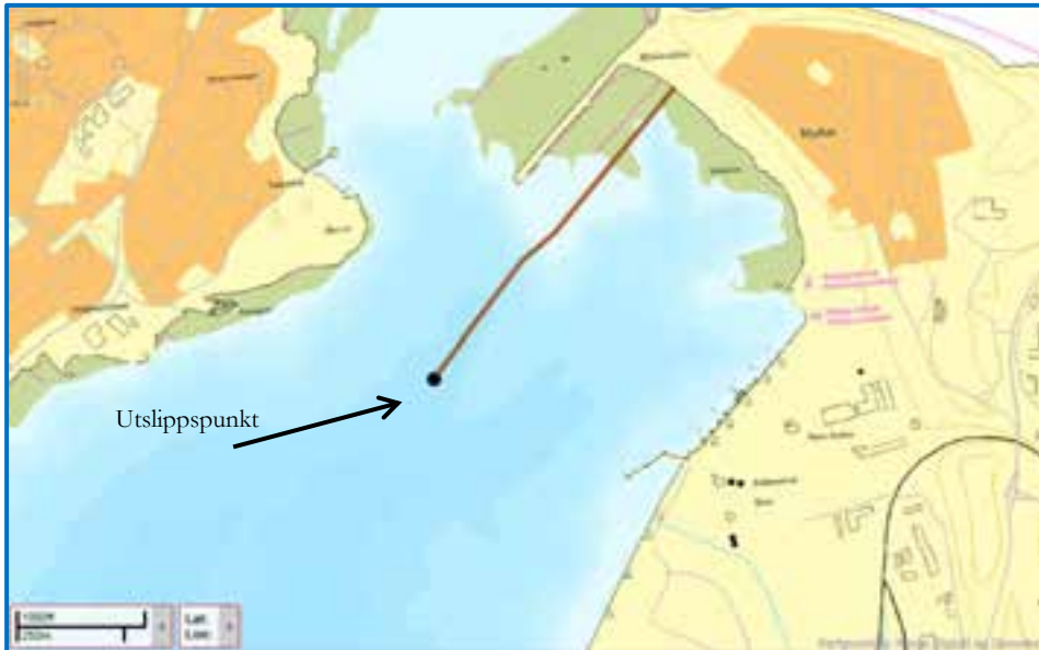
Figur 6. Kart med nytt felles utslippspunkt for grov- og finfraksjon for avgang fra Rana Gruber. Utslipppet er på 127 meters dyp.
