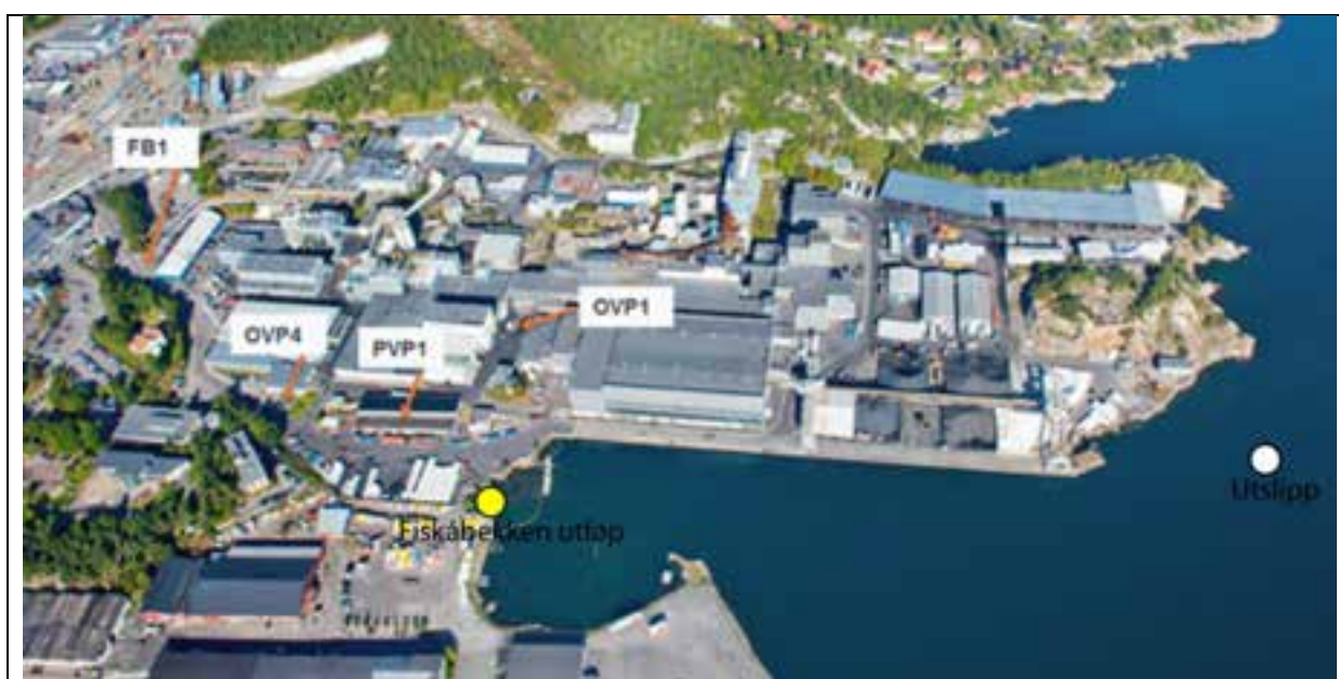
Figur 3. Utslippspunktet for Elkem Solar på ca 20 m dyp er vist med hvit sirkel. Målepunkter for PAH-forbindelser i vann fra overflateutslipp er merket OVP1 og OVP4. I Fiskåbekken blir det målt ved punkt FB1. Utløpet av Fiskåbekken er vist med gul sirkel. (Kilde: Bente Sundby Håland, Elkem Solar).
