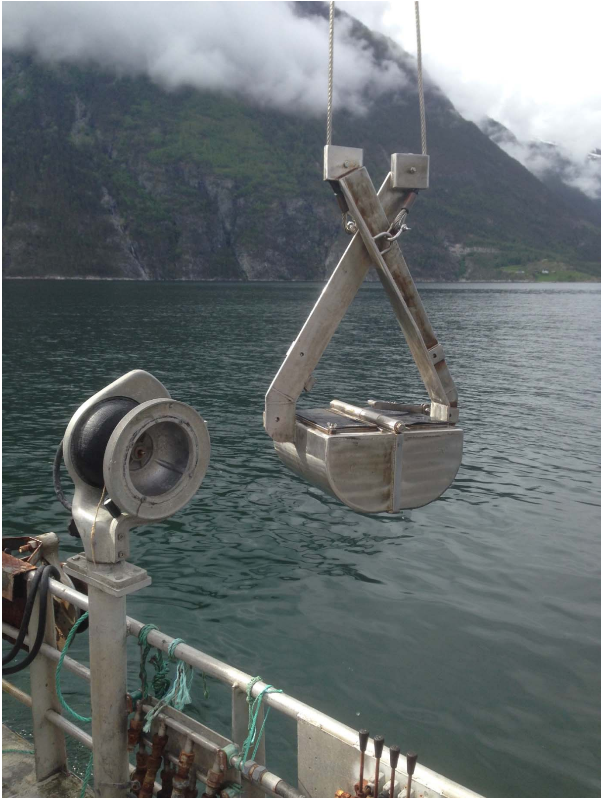
Figur 5 Prøvetaking av bunnfauna og sediment med van Veen-grabb i Årdalsfjorden i 2015
