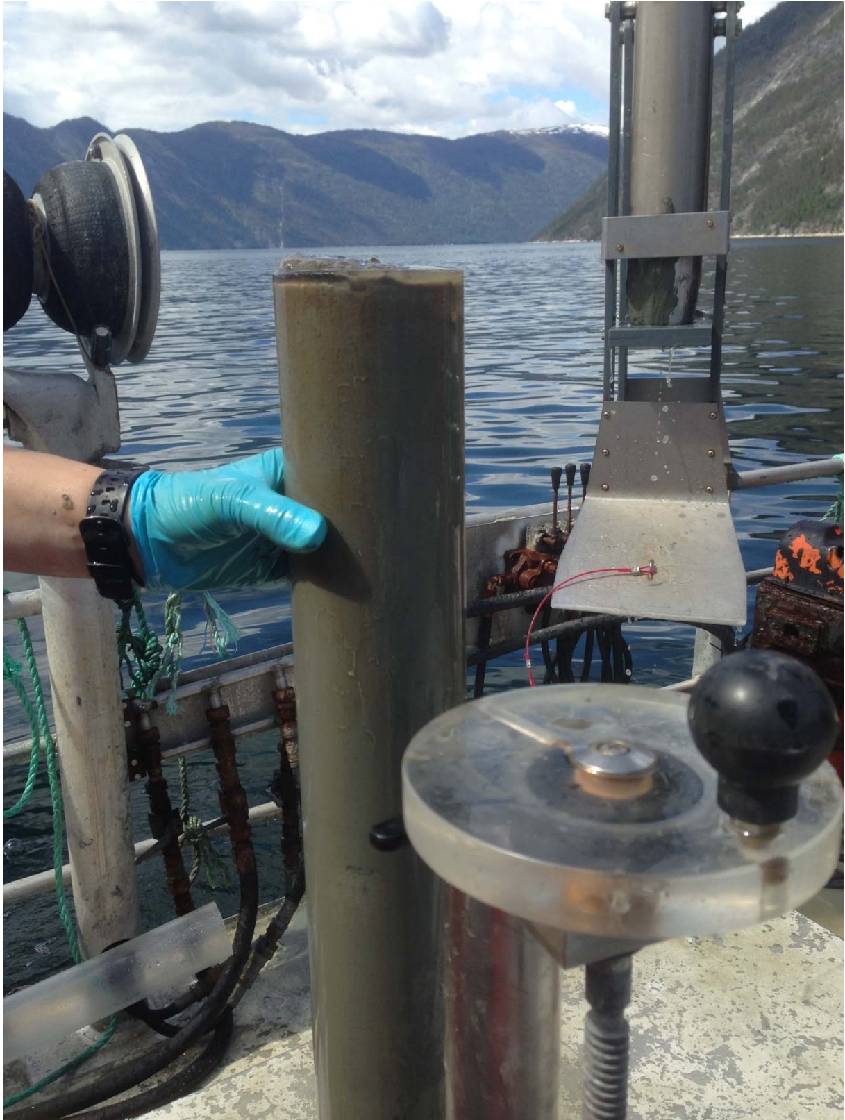
Figur 6 Prøvetaking av sediment med Gemini-corer i Årdalsfjorden 2015
