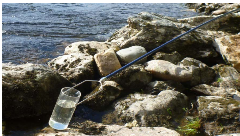
Figur 11: NIVAs teleskopiske vann-prøve henter (6 m), her brukt på stasjon 1 oppstrøms Moøya RA.
