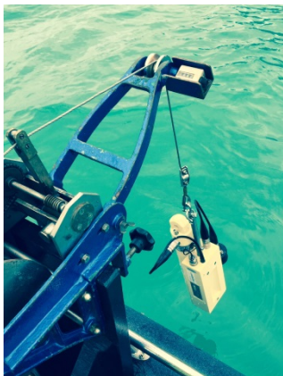
Figur 5. CTD sonde benyttet for måling av temperatur, konduktivitet og oksygen i vannsøylen
