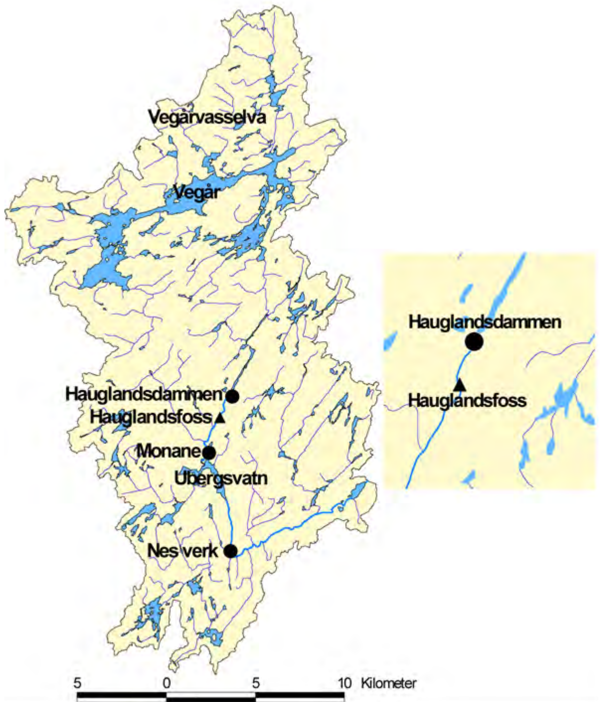
Figur 1. Storelva med nedbørfelt (457 km 2 ), med plassering av kalkdoseringsanlegg (trekant) og pH- målestasjoner (sirkler).
